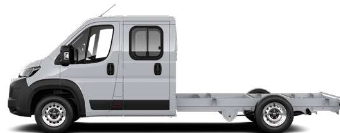
Leiterrahmen-Fahrgestell mit Doppelkabine
